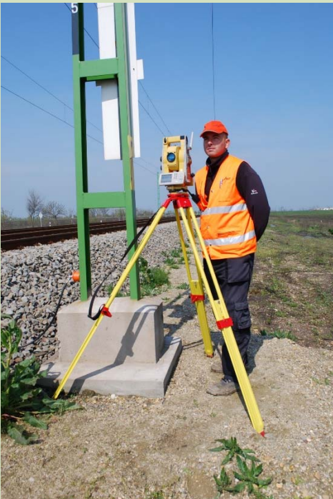
Maďarsko, Mezotúr-Nagylapos-Gyoma, zameriavanie koľají (robotizovaná totálna stanica Topcon GPT-9001A)
