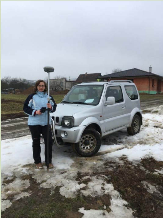
Župčany - vytýčenie hraníc pozemkov, r. 2018 prístroj: TRIMBLE R8 GNSS
