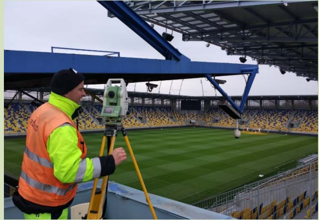
FC DAC 1904 Dunajská streda, zameranie jestvujúcich nosníkov strechy (robotizovaná totálna stanica Leica TCRP 1205+)
